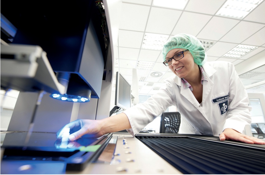
In der Produktion gelten Reinraumbedingungen gemäß DIN EN ISO 14644–1 Klasse 7, GMP-Klasse C © Pöppelmann
